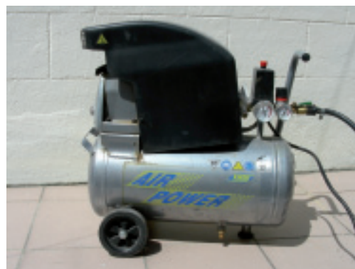
Perslucht drijft pneumatisch handgereedschap aan.
